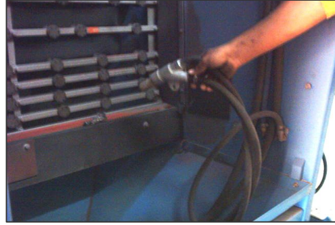
شكل (1) المعالجة بالسفح الرملي والتنظيف الكيميائي للعمل الفني من خام الحديد .
